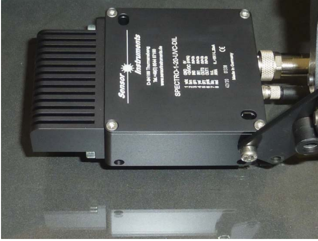
Bir düz camın alev tarafına 20 mm mesafe ile yönlendirilmiş olan sensör SPECTRO-1-20-UVC-DIL
