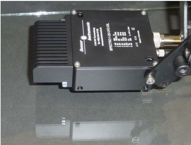
Düz camın kalay tarafına yerleştirilmiş olan sensör SPECTRO-1-20-UVC-DIL
